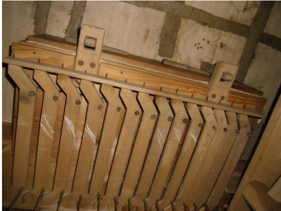
Wellenrahmen unter der Zusatzlade Oberwerk strahlenförmige Wippenscheide der Pedalkoppel
