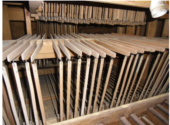
Wellenrahmen unter der Zusatzlade Oberwerk strahlenförmige Wippenscheide der Pedalkoppel
