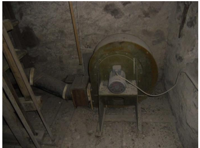
elektrischer Winderzeuger mit Drosselventil und Windzuleitung aus einem Papprohr
